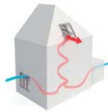
3 Hoch positioniertes Dachfenster zur Nutzung des Kamineffekts
